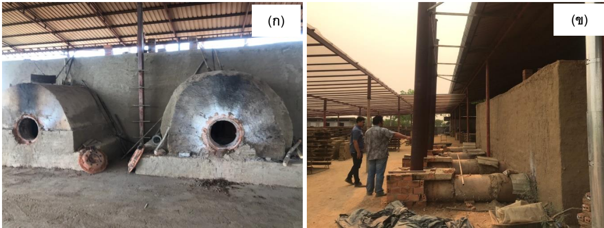
รูปที่ 2 แสดงภาพเตาเผาอิฐมอญแบบถมทรายหลังเตา (ก) ด้านหน้าเตาเผา และ (ข) ด้านหลังเตาเผา
