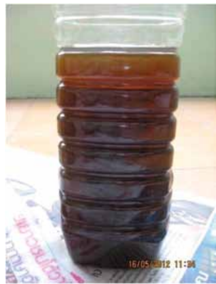
ภาพที่ 5 ผลผลิตที่เป็นของเหลวที่ได้จากการเผาแบบไพโรไลซิส (น้ำมันไพโรไลซิส) ที่มา : ศูนย์บริการวิชาการแห่งจุฬาลงกรณ์มหาวิทยาลัย (2563)
